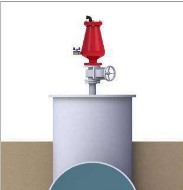
Ventosa única sobre llave de cierre a 45° de la salida de la ventosa
