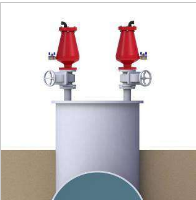
Dos ventosas sobre una trampa de aire con llaves de cierre separadas. Las salidas de las ventosas se dirigen hacia fuera y las llaves de cierre a 45° de las salidas de las ventosas
