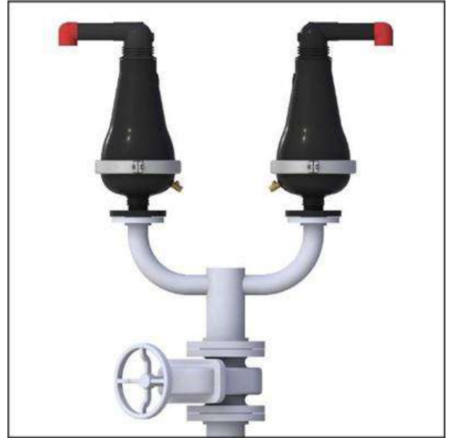
Dos ventosas sobre una llave de cierre compartida. Las salidas de las ventosas se dirigen hacia fuera y la llave de cierre a 45° de las salidas de las ventosas
