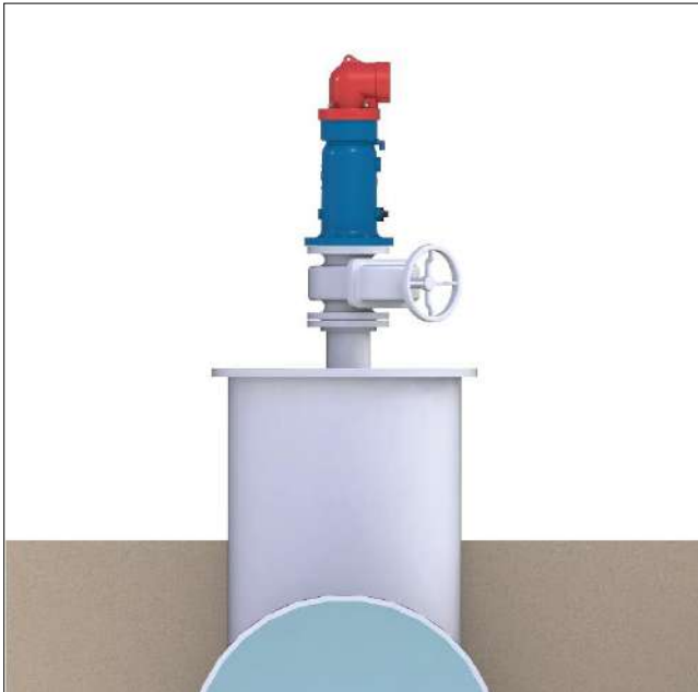
Ventosa única sobre llave de cierre a 45° de la salida de la ventosa
