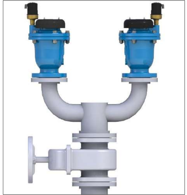
Dos ventosas sobre una llave de cierre compartida. Las salidas de las ventosas se dirigen hacia fuera y la llave de cierre a 45° de las salidas de las ventosas
