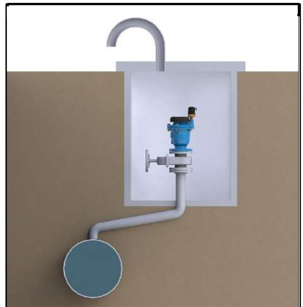
Dos ventosas sobre una llave de cierre compartida. Las salidas de las ventosas se dirigen hacia fuera y la llave de cierre a 45° de las salidas de las ventosas
